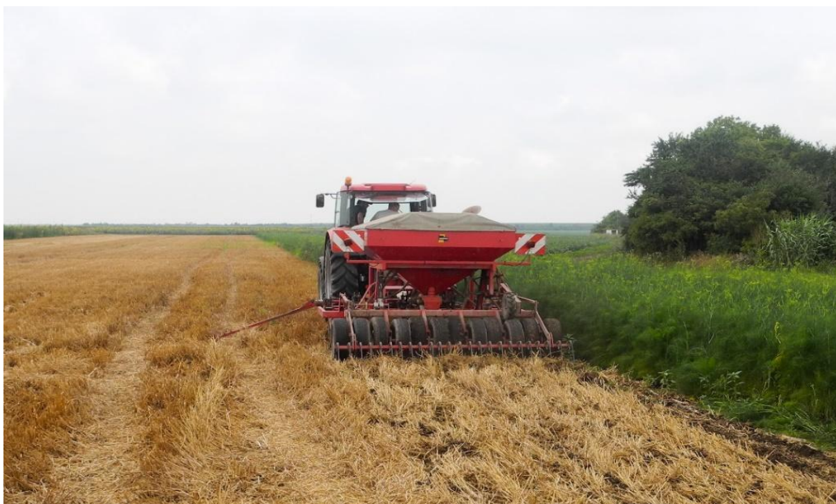
Slika 7: Setva cvetnog pojasa sejalicom za direktnu setvu (foto: Ugrenović V, 2014)
