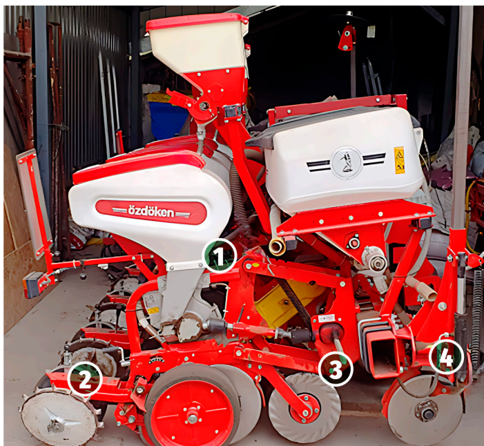
Slika 1. Obavezna oprema sejalice za širokorede useve u regenerativnoj poljoprivredi
