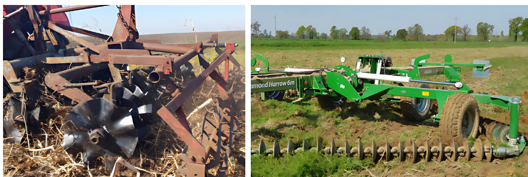
Slika 2. Adaptacija klasične tanjirače u „Crosscutter”, Kelly disk
